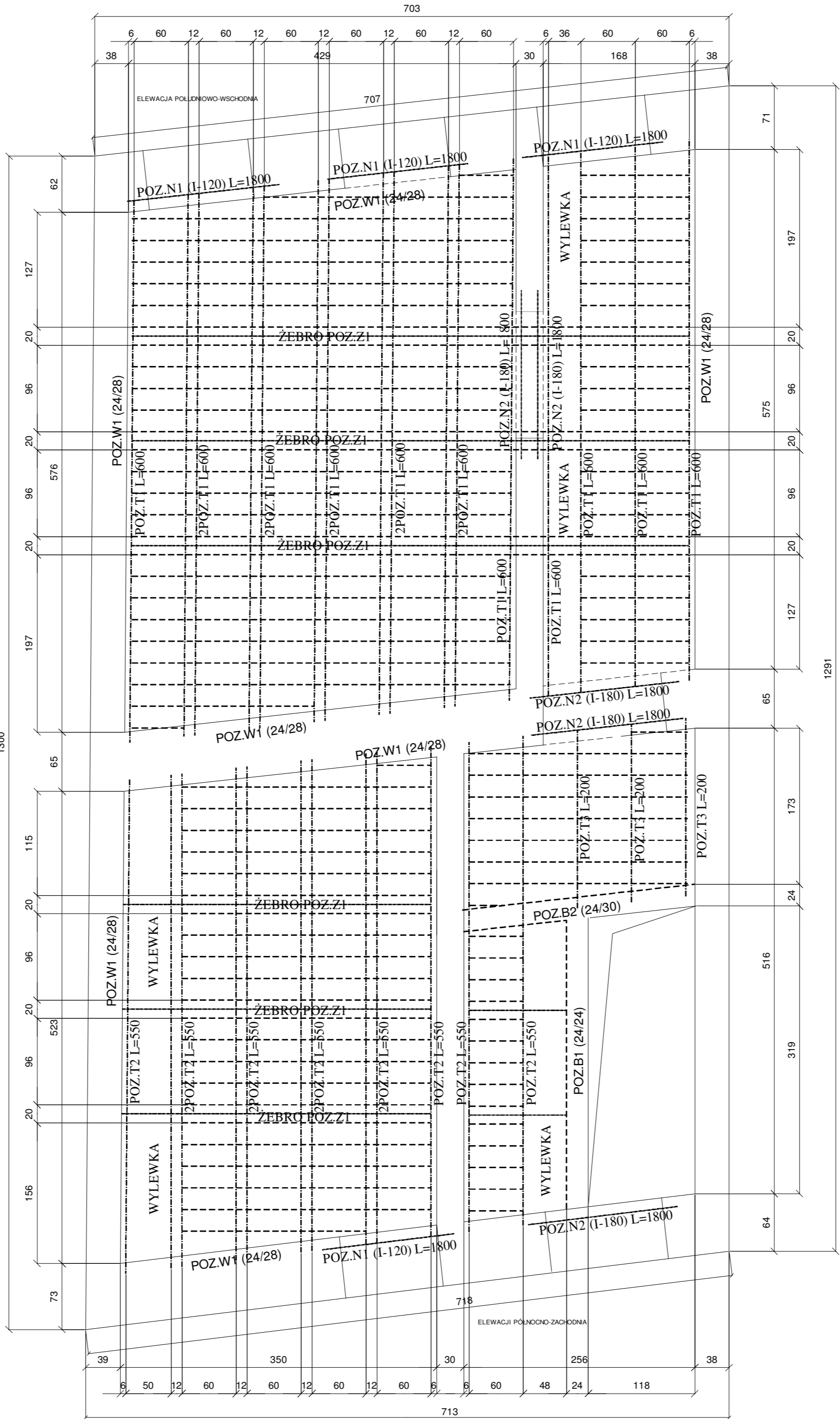
SCHEMAT - WYMIANA STROPU NAD I PIĘTREM BUDYNKU GŁÓWNEGO Z BELKOWEGO DREWNIANEGO NA GĘSTOŻEBROWY ŻELBETOWY
